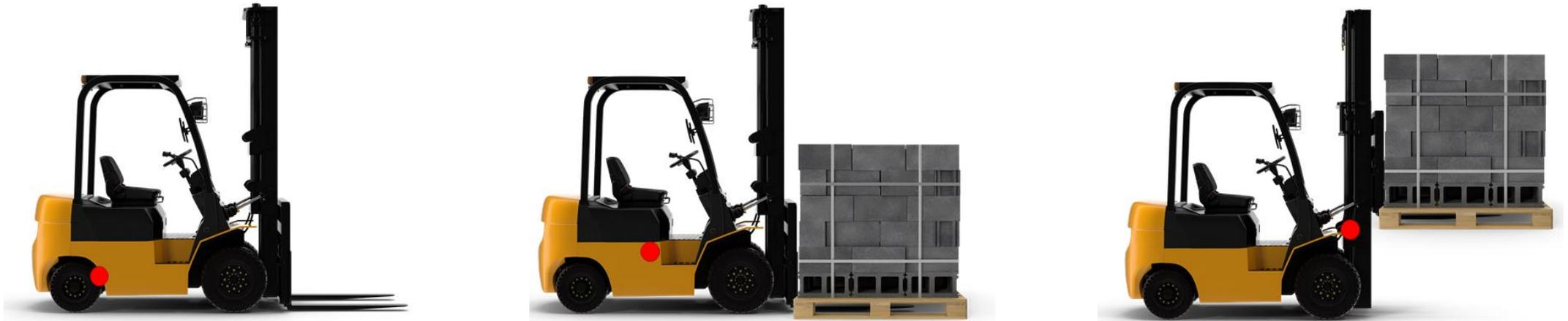
Le centre de gravité des chariots se déplace vers l'avant lors de la charge et vers le haut lors du levage. Il y a **risque de basculement** si ce centre de gravité se déplace trop en avant ou vers le haut : Masse de la charge supérieure à la capacité du chariot ou hauteur de levage trop importante.
